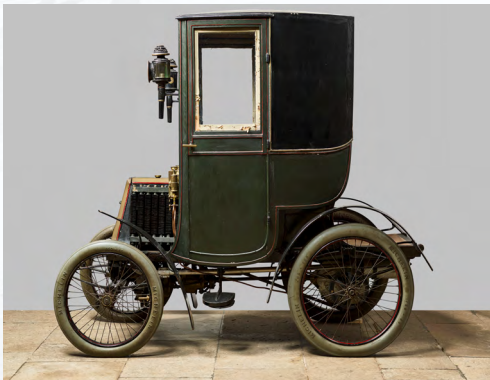
Petit coupé de ville Renault, type C Moteur de Dion-Bouton monocylindrique de 3 CV, allumage par magnéto. crédits : RMN-Grand Palais (domaine de Compiègne) / Tony Querrec
