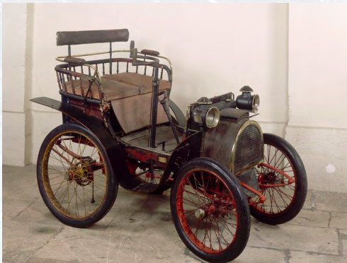
Voiturette Renault - Carrosserie du type Tilbury, moteur monocylindrique à ailettes de 1 3/4 CV fabriqué par la Firme de Dion-Bouton crédits : RMN-Grand Palais (domaine de Compiègne) / Jean-Pierre Lagiewski
